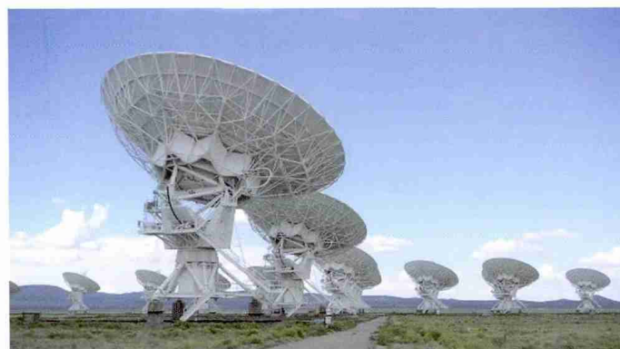
▲ 美国于 1981 年建成的甚大阵望远镜是世界上最大的综合孔径射电望远镜
