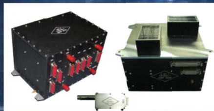
在嫦娥一号卫星上安装我国首台空 间半导体 X 射线探测器、首台月球 X 射线探测器和首台空间软 X 射线 能谱探测器
