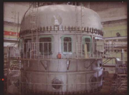
超导托卡马克核聚变实验装置
