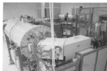
图 3 ^{14}\text{C} 专用加速器质谱计装置 [5]
