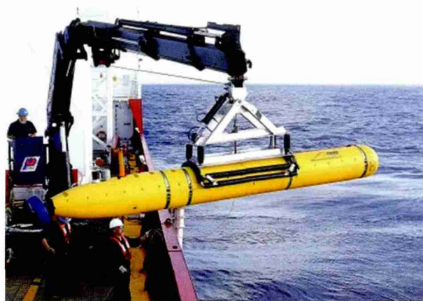
图1 美国的蓝鳍金枪鱼-21型战场准备自主式水下航行器
